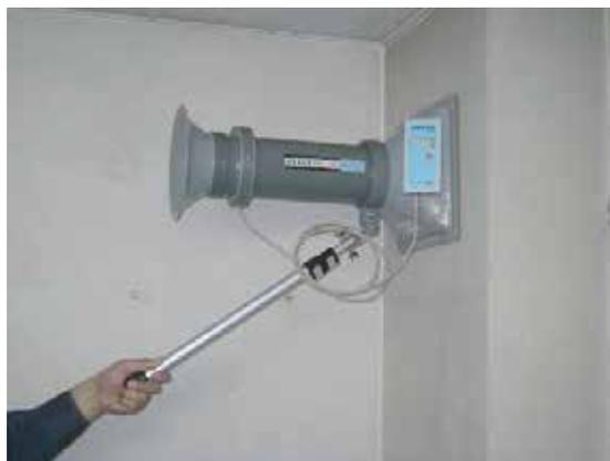
写真 2 24時間換気装置の風量測定の実施
